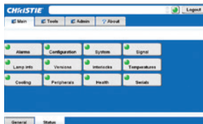
▲ Estado y diagnóstico: visualización de eventos de alarma para control y diagnóstico inmediato de proyectores
